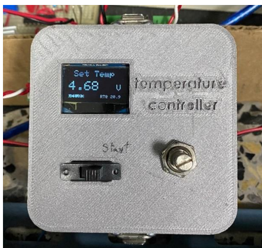
รูปที่ 30 อุปกรณ์ควบคุมอุณหภูมิที่ใช้จริงในงานทดลอง (ซ้าย) และแผ่น PCB วงจรวางจรควบคุมอุณหภูมิ (ขวา)
